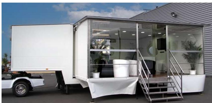
Cette petite semi-remorque est attelée à un tracteur 3t5, ce qui la rend peu encombrante. Des extensions latérales de 2m18 de chaque côté portent la surface utile à 38 m<sup>2</sup> ; le plancher et le toit sont hydrauliques pour faciliter la mise en place. Équipée de spots intégrés, d'un écran plasma, elle dispose en plus d'un espace de stockage. La solution mobile idéale pour vos événements itinérants et road shows.
